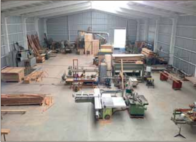
Europäische Technik für eine chilenische Schreinerei: Transportiert wurde sie u. a. in fünf Schiffscontainern, die mithilfe von kräftigen Mitarbeitern und einem Multifunktions-Gabelstapler entladen wurden – darunter Anlagen zur Furnierverarbeitung von Kuper, Pressen von Höfer und (natürlich) eine Tischkreissäge von Altendorf.
